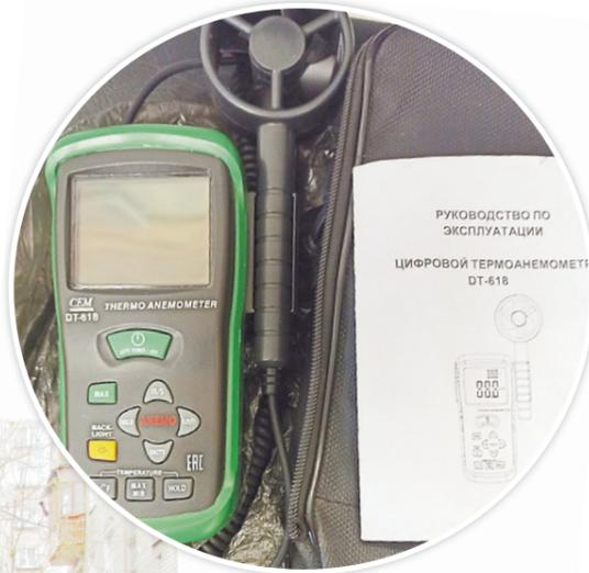
Анемометр – прибор для измерения потоков воздуха в вентиляционных системах многоквартирных домов.
